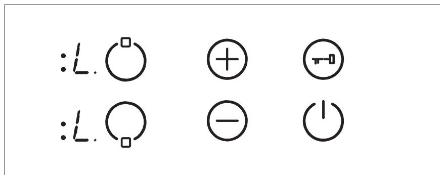
U slučaju da potsetnik za minute još uvek radi, nastaviće dok ne dođe na '00', a zatim će se oglasiti zvučni signal. Kada potvrdite isticanje tajmera, uređaj je potpuno zaključan. Sve dok je uređaj zaključan, ne može da se rukuje nijednim dugmetom.
