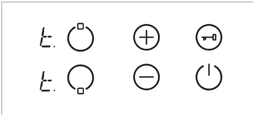
Ko temperatura pade, se napis 't' izbriše in kontrolna enota kuhalne plošče se vključi nazaj v način S. To pomeni, da lahko uporabnik ponovno vključi napravo z dotikom na tipko
