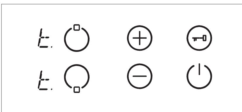
Kada temperatura opadne, slovo "t" se isključuje, a kontrolni sistem ploče za kuvanje vraća u *S-režim* rada. To znači da korisnik može ponovo uključiti uređaj pritiskanjem na ⏪.
