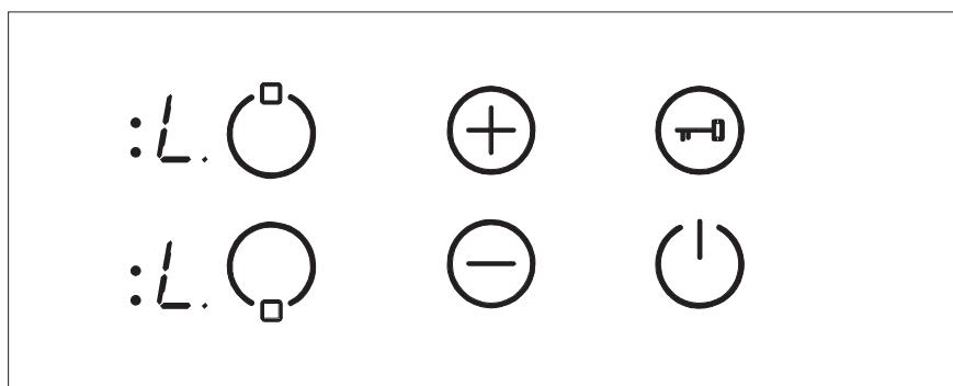
У случају када је још укључен минутни потсетник исти ће продужити одбројавањем до 00 и тајмер ће испустити звучни сигнал. Након потврду о истека тајмера апарат је потпуно закључан. Ни једно дугме не може се користити док је апарат закључан.
