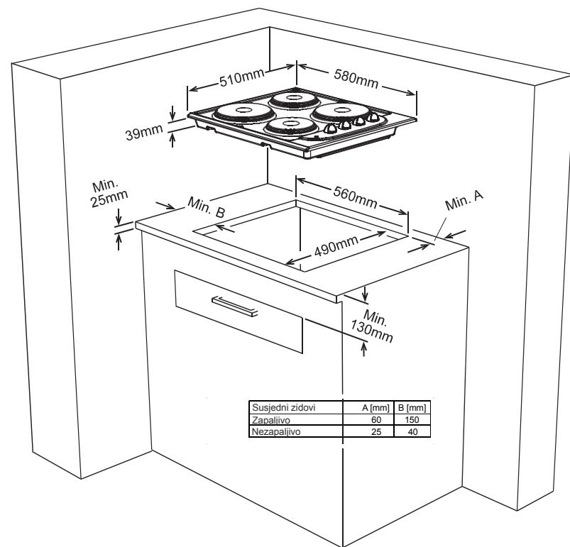
Ploča je opremljena posebnom trakom kako bi se izbjegao prođor tečnosti u radnu površinu. Izrežite otvor na površini vaše kuhinjske jedinice tako da odgovara mjerama koje su date na slici. Nanesite samoljepljivu traku na sve rubove otvora i pažljivo uklopite ploču za kuhanje na otvor tako da tipke budu na prednjoj strani. Pritegnite zatezanjem stezaljki kao na slici.
