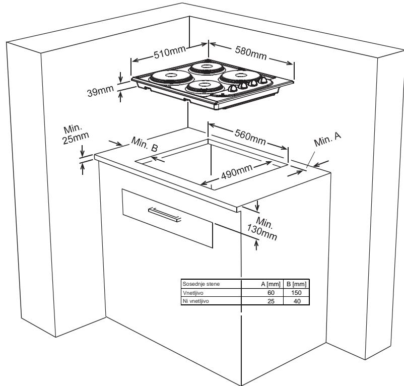
Kuhalna plošča je dobavljena skupaj s posebnim tesnilom, ki preprečuje vdor tekočin v delovno površino. Izrežite odprtino na vrhu kuhinjske enote, ki ustreza meram na sliki. Nanesite samolepljivo tesnilo na vse robove odprtine in previdno namestite kuhalno ploščo v odprtino, tako da so gumbi na sprednji strani. Zatesnite spojke in zavarujte, kot prikazuje slika.
