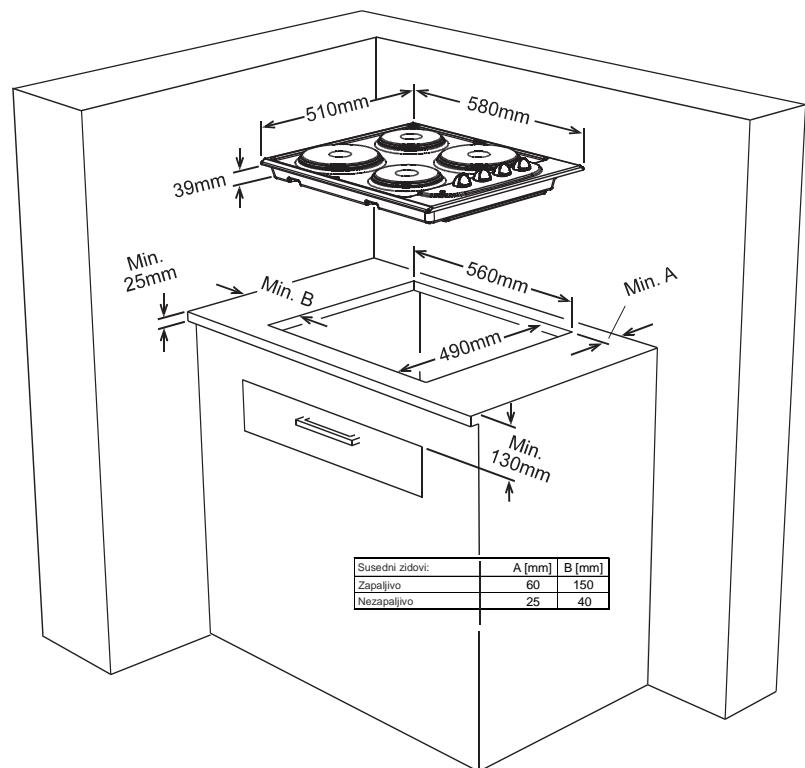
Ploča za kuvanje se isporučuje sa posebnim zaptivačem kako bi se sprečio ulazak tečnosti preko gornje površine. Isecite otvor na vrhu kuhinjskog elementa koji odgovara merama datim na slici. Postavite adhezivni zaptivač na sve ivice otvora i pažljivo postavite ploču za kuvanje u otvor tako da se dugmad nalaze na prednjoj strani. Pričvrstite je koristeći stege kao što je prikazano na slici.
