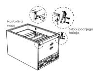
**4.** Namestite omejevalnik vrat in tulec osi na nasprotno stran
