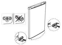
5. Coloque a porta na dobradiça inferior e monte a dobradiça superior com os parafusos.
