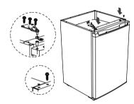
**6.** Preklopite pokrov rezila na zgornjem pokrovu z leve na desno stran. Pritrdite zgornji pokrov hladilnika.
