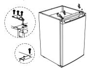
Mude a lâmina da tampa superior da esquerda para a direita e fixe a tampa superior do frigorífico.
