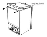
Desmonte a tampa superior, os parafusos de fixação da dobradiça superior e retire a dobradiça superior. Mantenha a porta na vertical durante todo o processo para evitar che caia.
