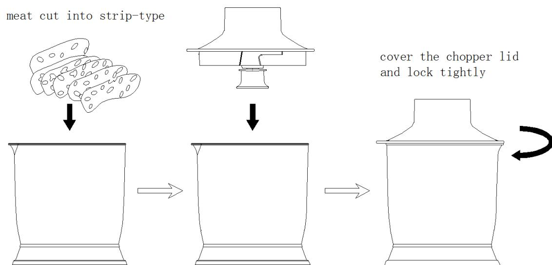
③ Vstavite pogonsko enoto v nastavek na pokrovu sekljalnika in jo zaklenite z obratom, nato pa
