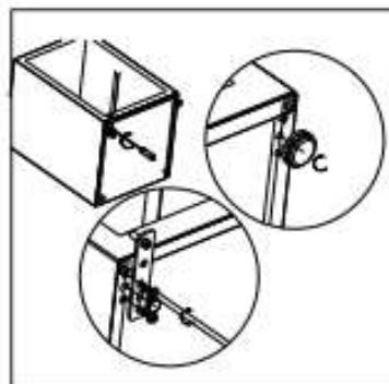
7. Stavite vrata, i proverite da li dolazi do okomitog i horizontalnog podudaranja i da li su zaptivke dobro zatvorene.
