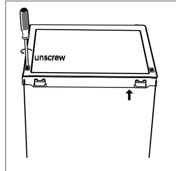
2. Retire la cubierta superior y déjela a un lado.
