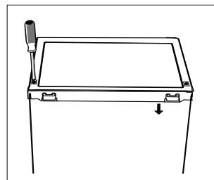
13. Odvojite zaptivke na vratima frižidera i zamrzivača, a zatim ih stavite ponovo nakon rotiranja.
