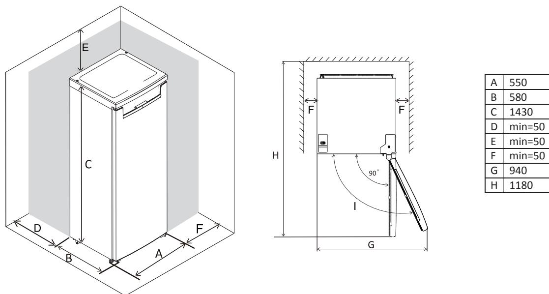
Nota: Este aparelho de refrigeração não se destina a ser usado como um aparelho embutido.
