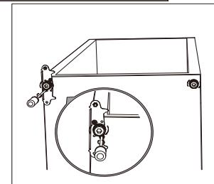
11. Stavite vrata, i proverite da li dolazi do vertikalnog i horizontalnog podudaranja i da li su zaptivke dobro zatvorene.
