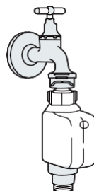
Mangueira de abastecimento de segurança
