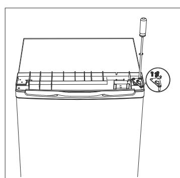
4. Desatornille la bisagra inferior, luego retire las patas ajustables de ambos lados.
