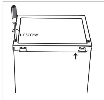
2. Retire la cubierta superior y la perilla del termostato, luego déjelas a un lado.
