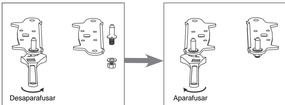
6. Reinstale o suporte encaixando-o na cavilha da dobradiça inferior e substitua os dois pés ajustáveis.
