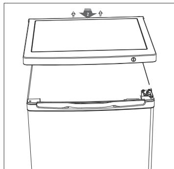
3. Desparafuse a dobradiça superior, remova a porta e coloque-a sobre uma superfície suave para evitar riscos e outros danos.
