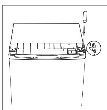
4. Desaparafuse a dobradiça inferior. De seguida, remova os pés ajustáveis de ambos os lados.
