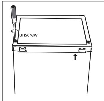
2. Odstranite zgorno ploščo i gumb termostata, ter ju ločeno shranite.
