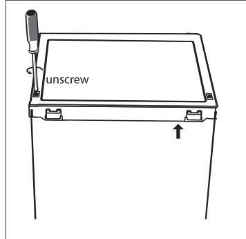
2. Remova a tampa superior e o botão do termostato e coloque-os de parte.
