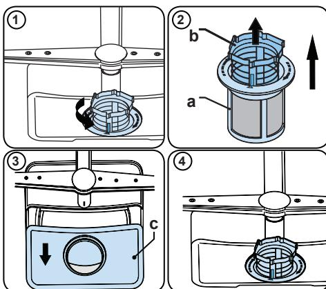
Da biste uklonili i očistili kombinaciju filtera, okrenite je u smeru suprotnom od kazaljke na satu i izvadite je podižeći prema gore (1). Izvucite grubi filter iz mikro filtera (2). Zatim izvucite i uklonite metalni filter (3). Isplaknite sa mnogo vode dok se ne očiste ostaci. Ponovo sklopite filtere. Zamenite uložak filtera, i okrenite ga u smeru kazaljki na satu (4).
