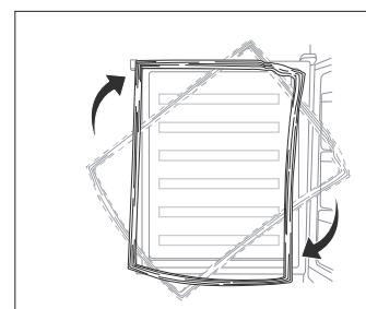
8 Ponovo postavite vrata. Uverite se da su horizontalno i vertikalno u ravni, kako bizaptivke bile zatvorene sa obe strane pre konačnog zavrtanja gornje šarke.
