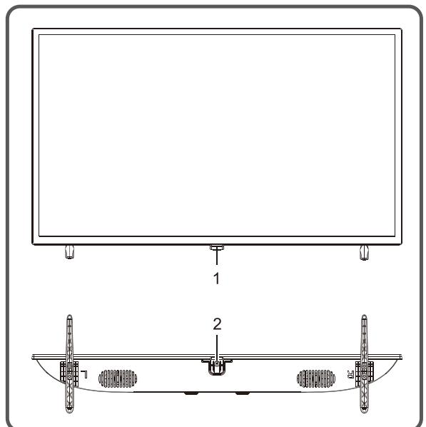
1. LED indikator napajanja in sprejemnik signala daljinskega upravljalnika.
