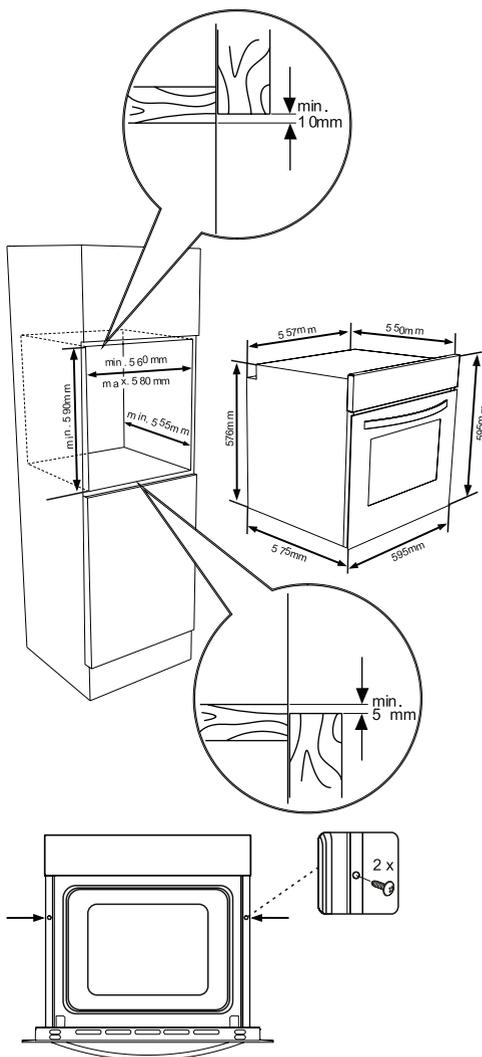
Pečico vstavite v ohišje tako, da jo potisnete navznoter. Odprite vrata pečice in vstavite 2 vijaka v luknji na ogrodju pečice. Ko se ogrodje dotika lesene površine ohišja, zategnite vijaka.
