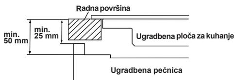
Ako pećnicu ugrađujete ispod ploče za kuhanje, razmak između radne površine i gornjeg dijela ploče pećnice mora biti minimalno 50 mm, a razmak između radne površine i gornjeg dijela upravljačke ploče mora biti minimalno 25 mm.
