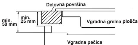
Če je pečica nameščena pod grelna ploščo, mora biti najmanjša razdalja med delovno površino in zgornjo ploščo pečice 50 mm in razdalja med delovno površino in vrhom upravljalne plošče najmanj 25 mm.
