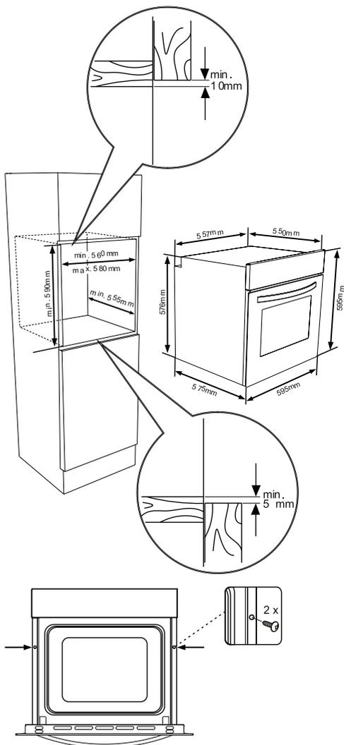
Ubacite rernu u ormarić tako što ćete je gurnuti napred. Otvorite vrata rerne i ubacite 2 šrafova u rupe koje su locirane na okviru rerne. Dok okvir proizvoda dodiruje drvenu površinu ormarića, zategnite šrafove.
