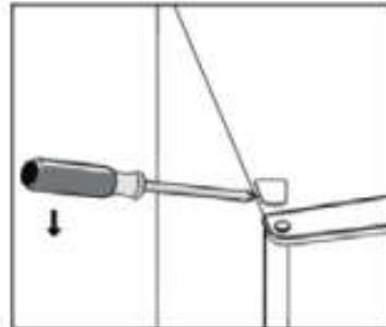
4. Premaknite pokrov jedra z leve na desno stran. Nato dvignite zgornja vrata in jih položite na oblazinjeno površino, da preprečite praske.
